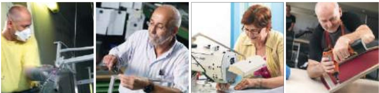
Qualität wird bei Karasek-Produkten in allen Arbeitsschritten sichtbar. Unsere Modelle werden unter größtem Bedacht auf Design und Komfort im eigenen Haus entwickelt. Die Einzelteile unserer Metallmöbel werden von Hand raupengeschweißt, in einer modernen Anlage pulverbeschichtet und sorgfältig geprüft. Dieselbe Qualitätskontrolle gilt auch für unsere das Sortiment ergänzenden Handelswaren. In der Näherei fertigen wir die Bezüge und Kissen aus ausgesuchten, hochwertigen Stoffen.
